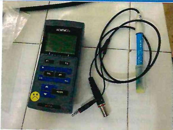
Medidor de pH portátil WTW modelo pH3210.
