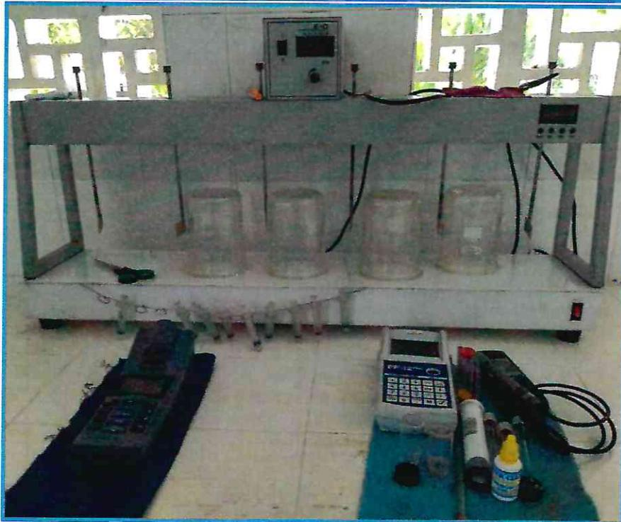
**Equipo test de jarras:** Ubicado dentro del laboratorio de la PTAP, se opera con 4 Beakers o 4 jarras. Este equipo permite programar secuencialmente las tres etapas (mezcla rápida, mezcla lenta y reposo para sedimentación). Otros equipos de laboratorio para análisis de parámetros de agua cruda y tratada: Turbidímetro, Fotómetro y pHmetro.
